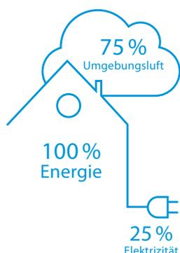
Wärmepumpen entziehen der Außenluft auch bei niedrigen Temperaturen Wärme. Das Kältemittel verdampft im Wärmetauscher des Außengeräts und nimmt dabei Wärme auf. Wenn Sie Ihren Finger befeuchten und auf die feuchte Stelle pusten, trocknet die Feuchte und an der Stelle entsteht ein Kältegefühl. Dieses Kältegefühl entsteht durch das gleiche Prinzip: Verdampfung entzieht Wärme.
