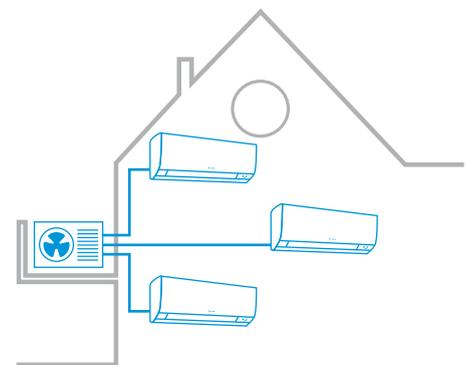
Lösung mit nur einem einzigen Multi-Split-Außengerät
